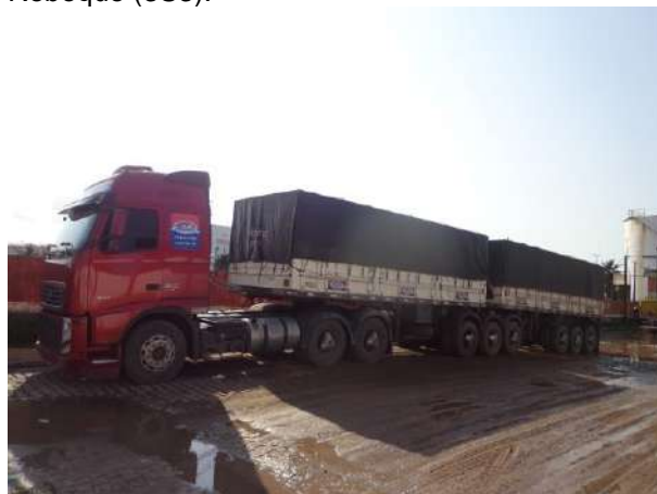
Foto 6 – Rodotrem (caminhão trator trucado + dois semi reboques Dom Dolly), (3T6).
